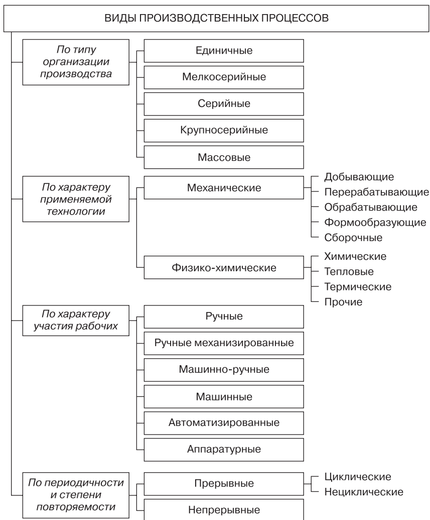
Рис. 14.2. Классификация производственных процессов
